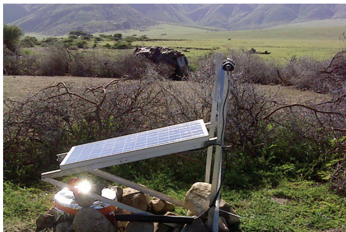
Comprendre les relations existant entre environnement et société dans le rift nécessite de nombreuses interactions entre disciplines et des mesures de terrain variées. Ici une station sismologique temporaire enregistrant l'activité sismique et volcanique en Tanzanie © Christel Tiberi
