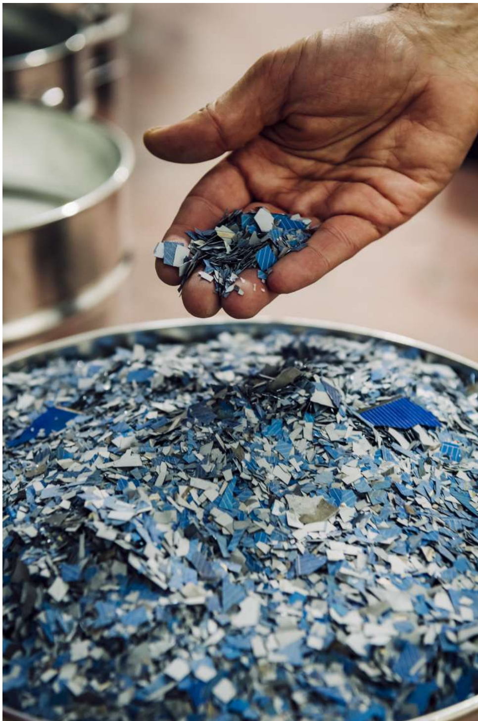
Éléments dissociés, extraits d'un ancien panneau photovoltaïque usagé, dans l'usine ROSI Alpes. © Cyril FRESILLON / Simap / SOLAR / CNRS Images
