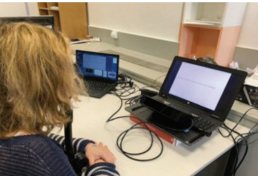
Système Eyelink, basé sur l'oculométrie, une technique d'enregistrement des mouvements oculaires consistant à repérer, en temps réel et avec une haute précision spatiale et temporelle, la position du regard, au moyen d'une caméra vidéo © Coralie Vincent
