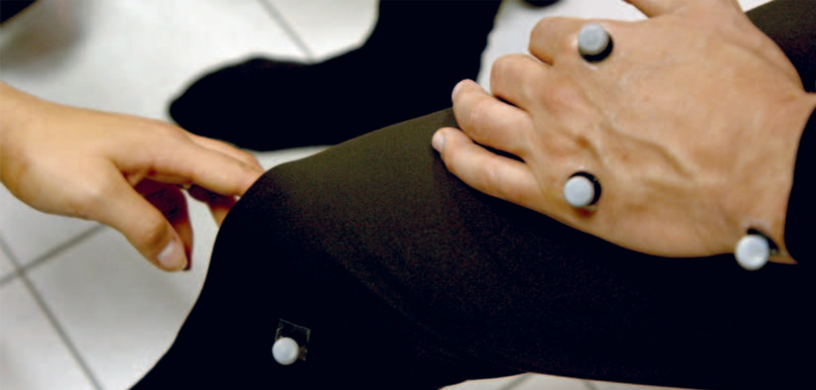
Installation des marqueurs passifs sur les membres du danseur en vue de la captation du mouvement par le système multi-caméras. Laboratoire RoBioSS, Institut PPrime, Université de Poitiers, 23 avril 2025. Photogramme David Gamet
