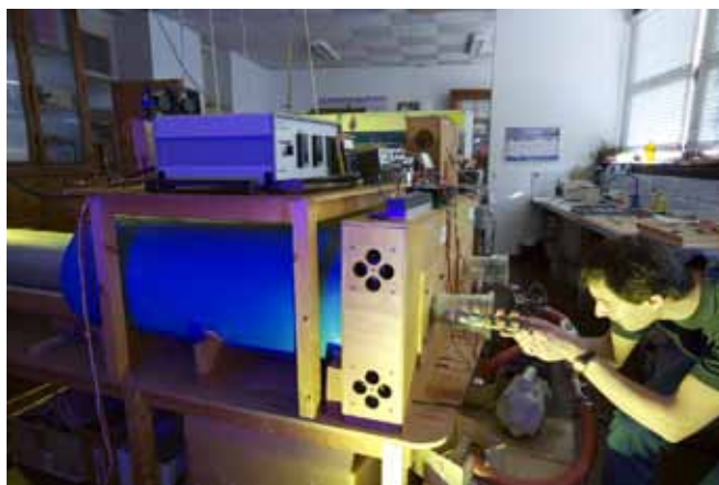
Mise en place des échantillons de briques dans un four à désaimantation. Le but de cette manipulation : vérifier que l'aimantation portée par la brique est une image fidèle du champ magnétique terrestre qui l'a créée. C'est seulement après cette étape que la datation est possible. © IRAMAT-CRP2A CNRS photothèque / C. Lebedinsky
