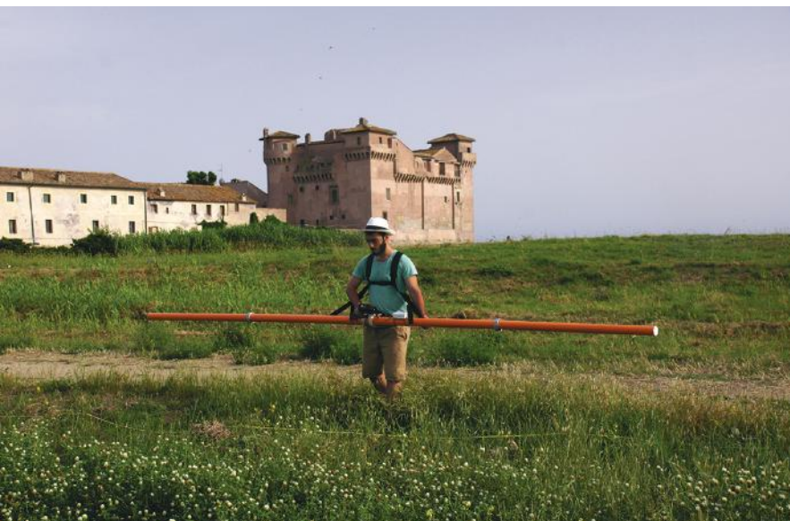
Prospection électromagnétique sur le site étrusque de Pyrgi (Santa Severa, Italie) © Christophe Benech / GEO-HERITAGE
