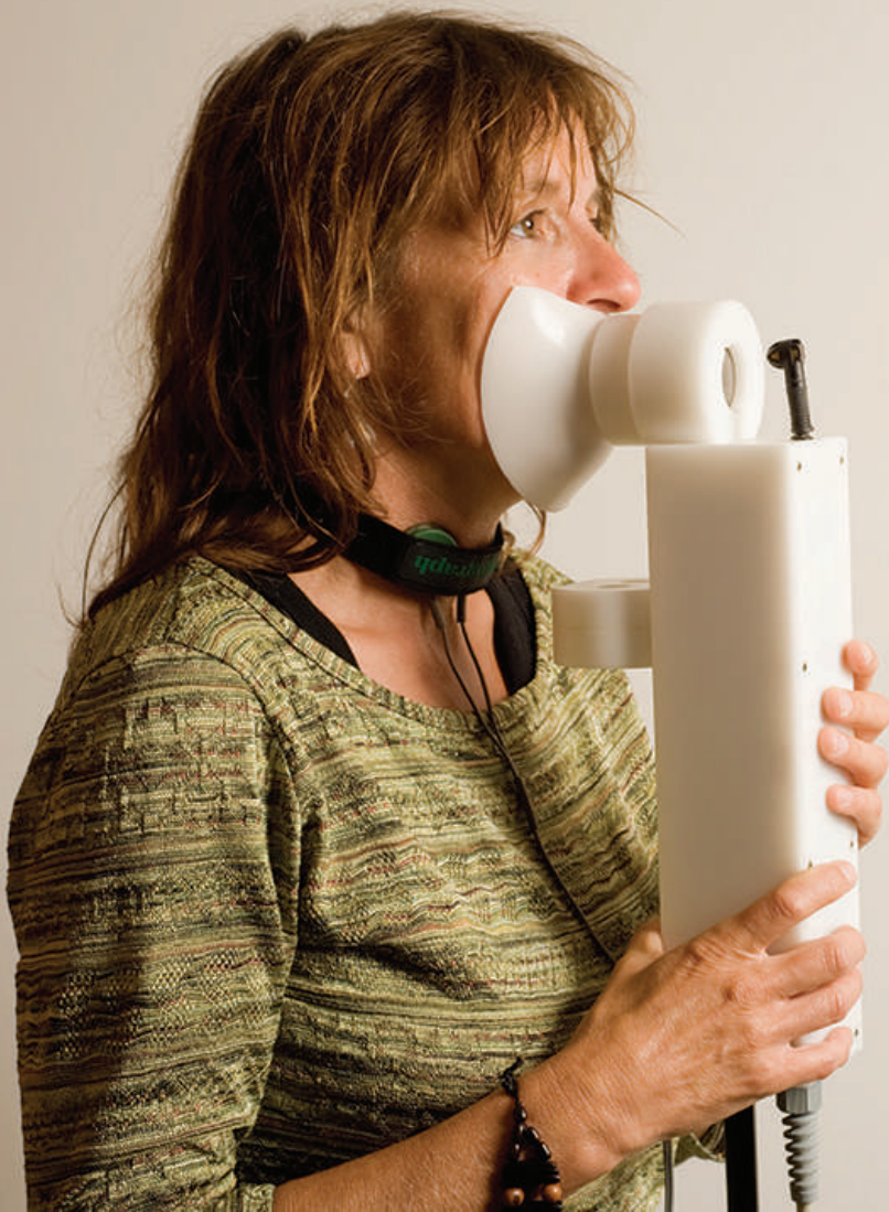
Le système EVA2 (Evaluation Vocale Assistée) est un système d'aide au diagnostic des pathologies vocales. Il analyse la plupart des paramètres intervenant dans le mécanisme de production de la parole © Jean-Claude MÖSCHETTI/CNRS Photothèque
