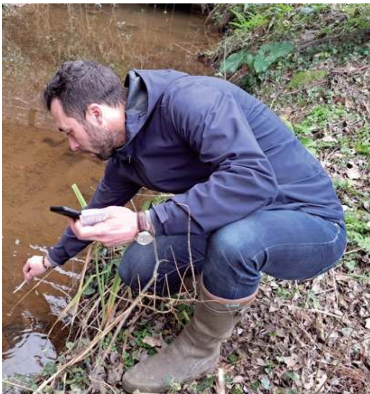
Photo 1 : La bandelette est plongée dans le cours d'eau durant une seconde © V. van Tilbeurgh
