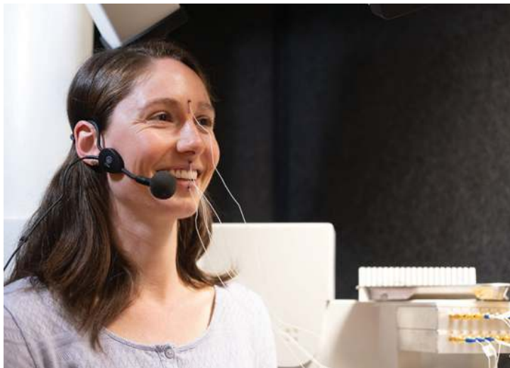
L'articulographe électromagnétique (EMA), technique permettant d'enregistrer les mouvements des organes articulatoires, grâce aux capteurs collés sur la langue et les lèvres © LPP
