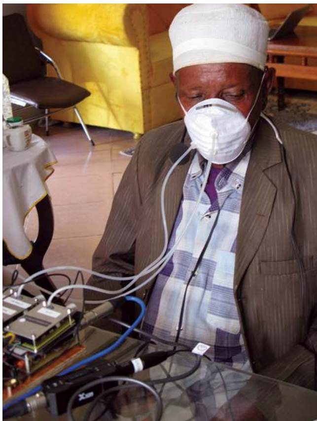
L'Aeromask est une technique qui permet de prendre des mesures aérodynamiques sans distorsion acoustique © LPP
