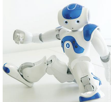
Robot humanoïde NAO qui possède différents capteurs (tactiles, visuels, auditifs) lui permettant d'interagir avec son environnement.
