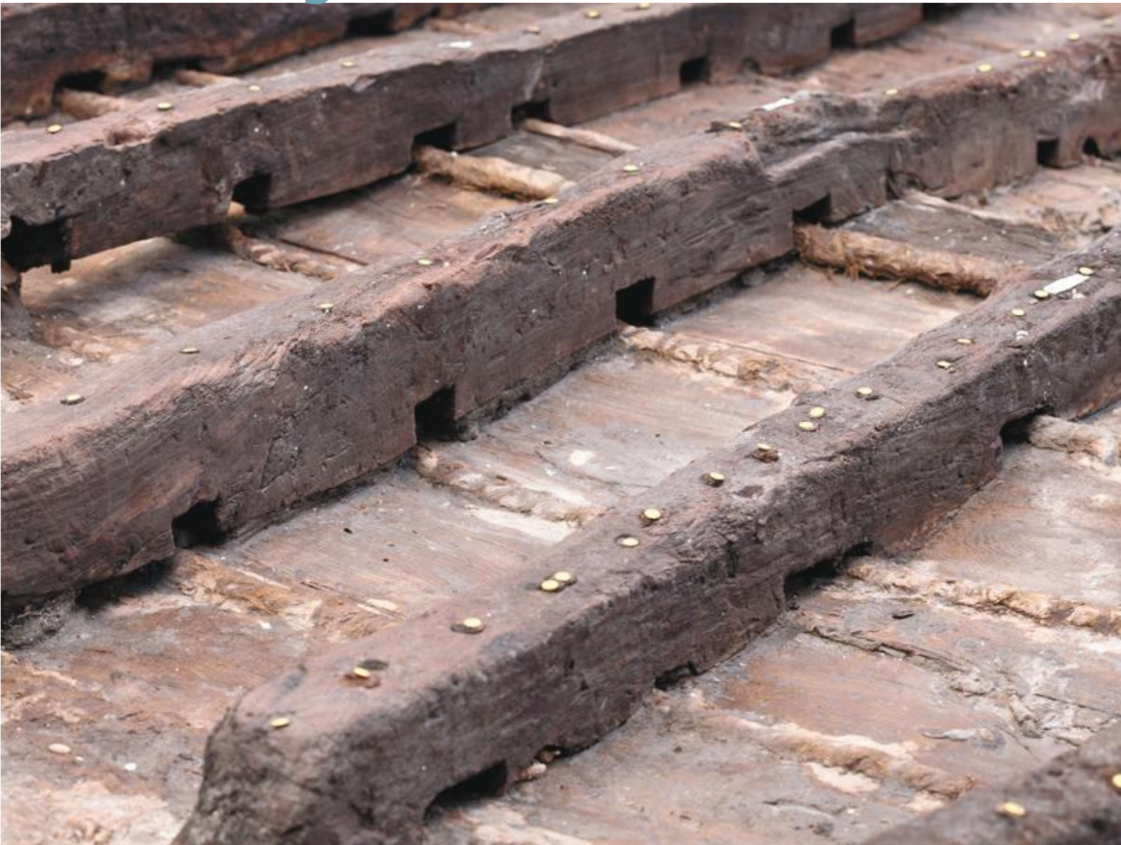
Vue de la membrure de l'épave Pula 1 : le pied de ces pièces transversales est entaillé pour éviter l'écrasement des ligatures © Arheološki muzej Istre, cliché T. Brajković
